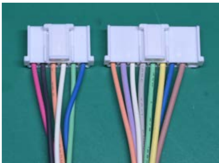
左 システム(6線) / 右 センサー(8線)
